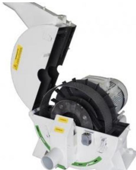
**Рисунок 10 - Пневматическая дробилка кормов ДКР**
