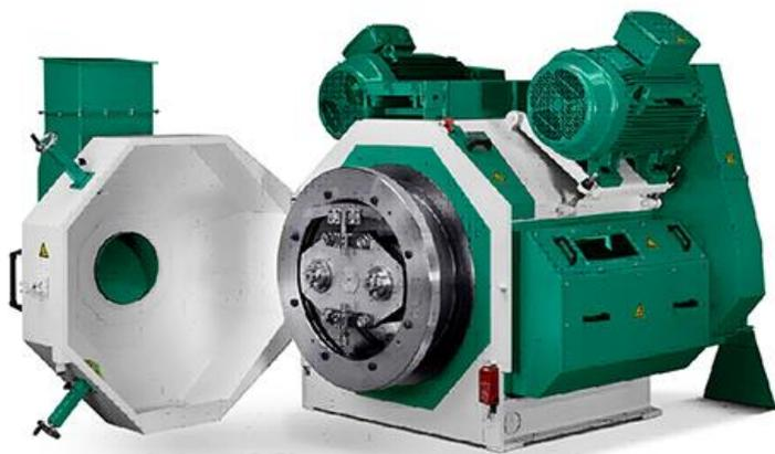
**Рисунок 12 - Пресс-гранулятор**
