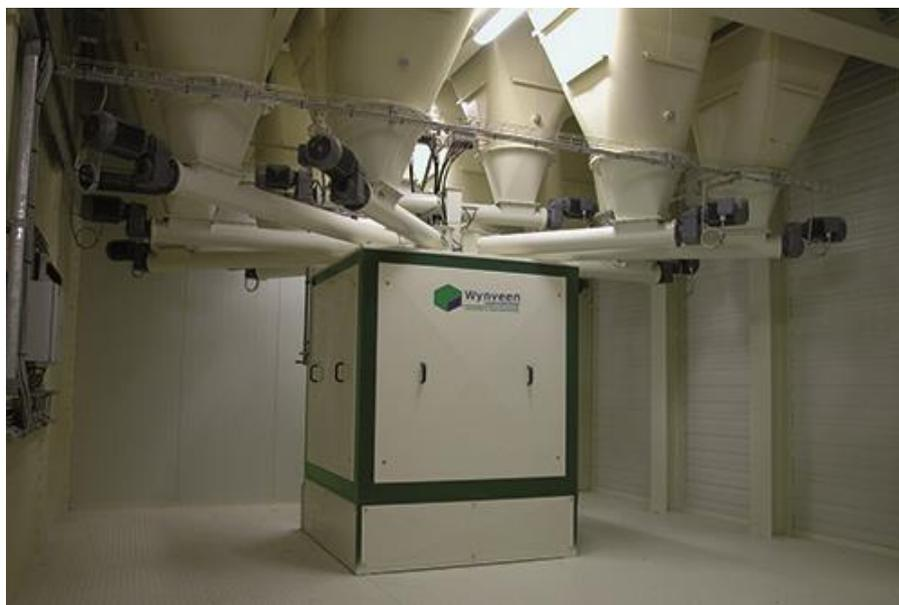
**Рисунок 8 - Система дозирования и взвешивания**
