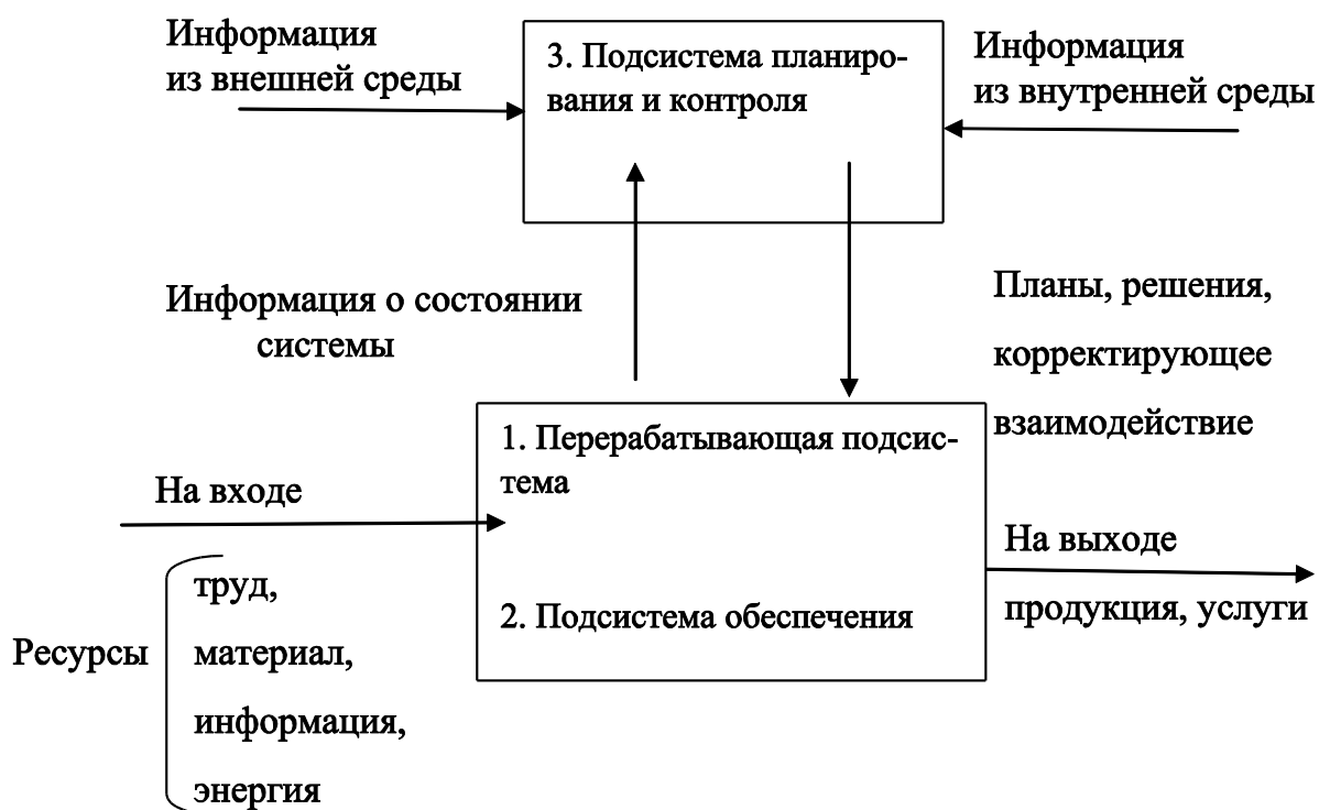
Рисунок 1 - Операционная система, включающие подсистемы: 1 - перерабатывающая; 2 - обеспечения; 3 - планирования и контроля
