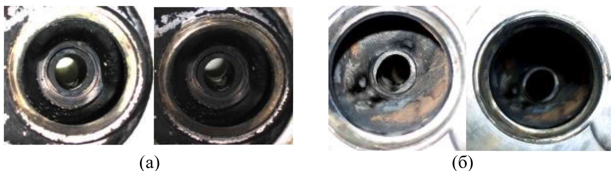
Рисунок 1 – Аварийный износ направляющих втулок и седел бензиновых (а) и дизельных двигателей (б)
